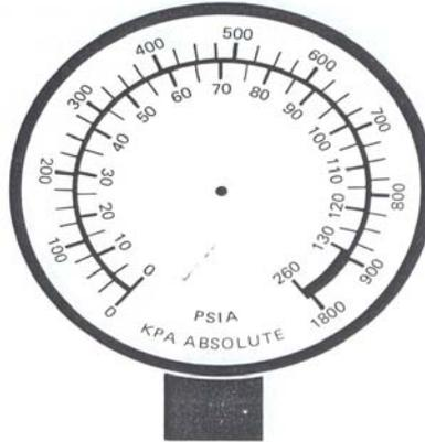
Gambar 2.8 Skala pengukuran tekanan absolut
