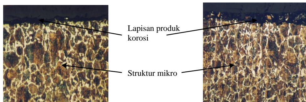
Gambar 1. Foto Struktur mikro Penampang Sampel ST-37 setelah perlakuan korosi : (a) T = 25^{\circ}\text{C} dan (b) 65^{\circ}\text{C} , pada \text{pH} = 4,5 selama 6 jam. (Etsa Nital 3%, pembesaran 200 X)
