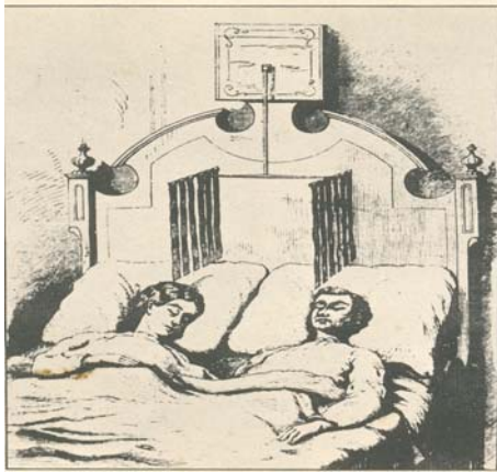
Gbr.4 Mekanisme jam menggerakkan Peralatan kipas
