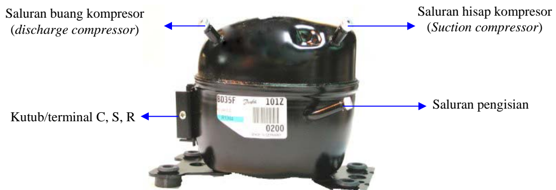
Gambar 5.3 Kompresor tipe hermetik
