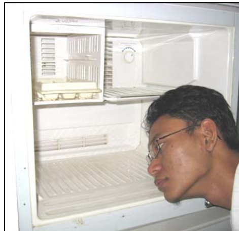
Gambar 6.3 Suara gemericik di evaporator
