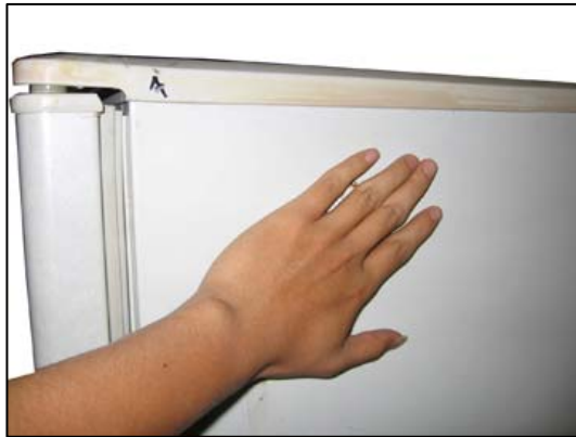
Gambar 6.2 Dinding lemari es terasa hangat
