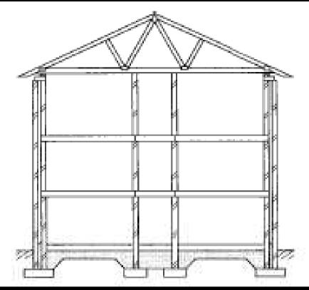
Denah tipikal dari struktur dinding pemikul beban berlantai banyak. Struktur lantai berupa plat satu arah yang terletak antara dinding struktural paralel. Dinding dlm arah ortogonal bekerja sebagai elemen penopang (bracing)
