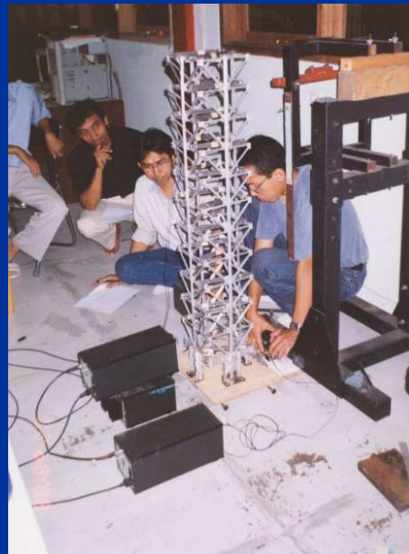
Menghubungkan Model dengan Alat Uji
