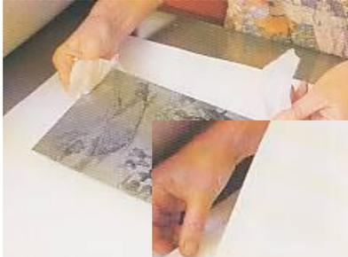
Gambar 27. meletakkan plat di atas bed.
