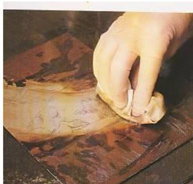
Gambar 24. Lapisan penutup (aspal) pada plat dihapus dengan terpentin. Untuk mencapai bersih sempurna, ulangi pencucian dengan sabun dan air.
