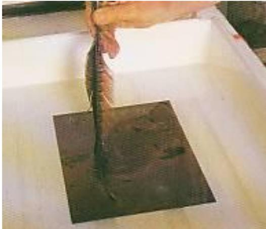
Gambar 21. Proses pengasaman (pengetsaan), gelembung yang terbentuk karena reaksi asam dengan logam, segera disapu dengan bulu ayam.
