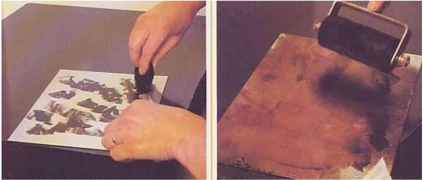
Gambar 17. Cara pengenaaan lapisan anti asam ke permukaan plat, kemudian diratakan dengan roller.
