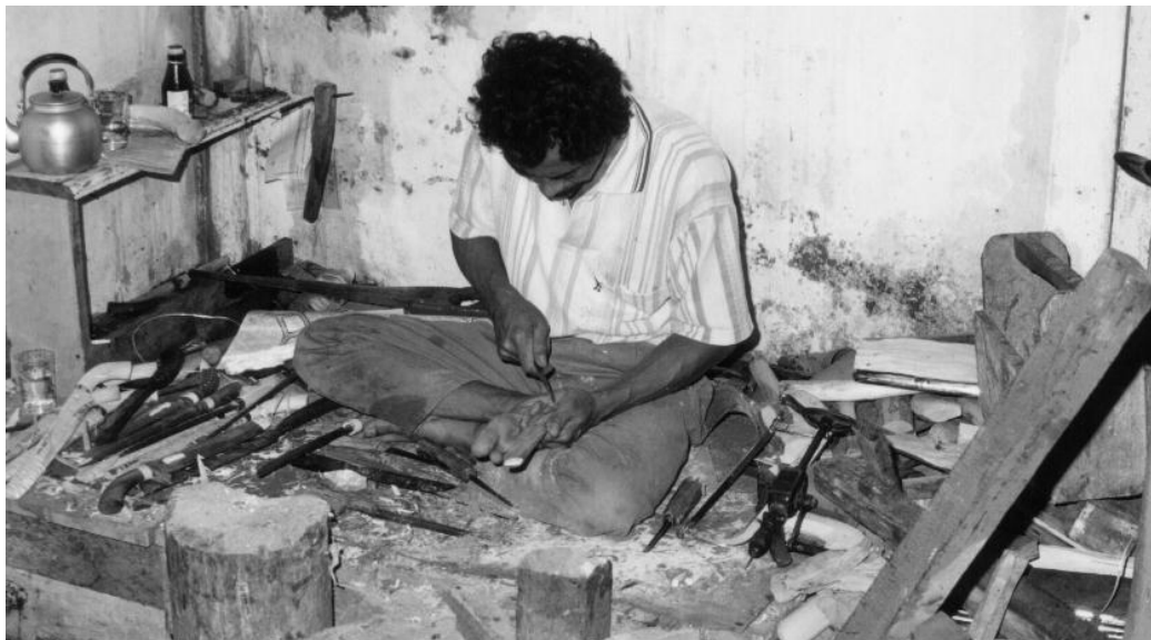
Gambar Orang Desa Mekarmaju Kab. Bandung sedang membuat warangka (sarung) golok dengan tangan, dan dibantu oleh alat sederhana, pisau.
