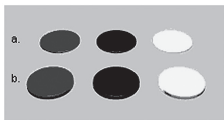
a. Keping Lingkaran, diameter 6 cm, tebal 2 mm b. Keping Lingkaran, diameter 6 cm, tebal 5 mm
