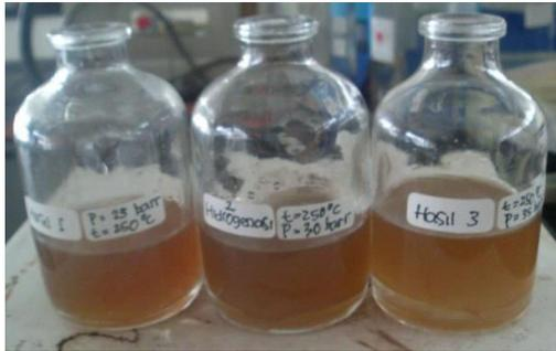
**Gambar 5.20.** Tampilan fisik hasil reaksi *hydrocracking* untuk variabel tekanan saat reaksi 23, 30, dan 34 kg/cm<sup>2</sup> pada suhu 250 °C (katalis 1%, waktu reaksi 2 jam)
