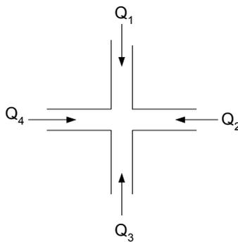
Gambar 5.9. Aliran pada sambungan
