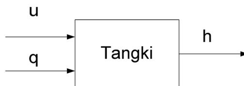
Gambar 3.2 diagram blok yang mendeskripsikan bagaimana ketinggian dalam tangki tergantung pada arus masuk dan arus keluar
