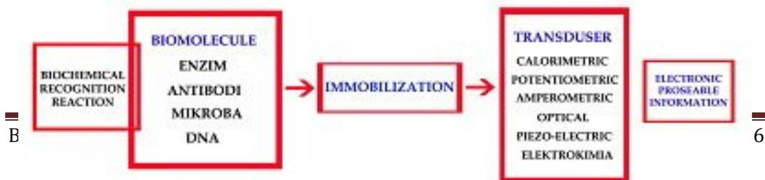
transduser elektrokimia, optoelektronik, kristal piezoelektronik, *field effect* transistor dan temistor. Proses yang terjadi dalam transduser dapat berupa *calorimetric* biosensor, *potentiometric* biosensor, *amperometric* biosensor, *optical* biosensor maupun *piezo-electric* biosensor. Sinyal yang keluar dari transduser ini kemudian di proses dalam suatu sistem elektronik misalnya *recorder* atau komputer. Berikut adalah contoh skema umum dari biosensor :
