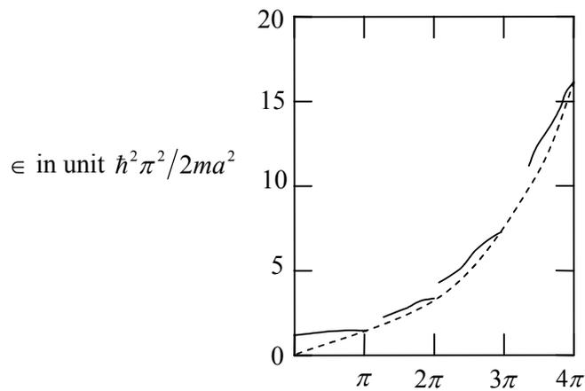
Gambar 6. Daerah antara energi dan nomor gelombang untuk potensial Kronig-Penney, dengan
