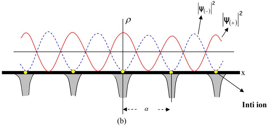
Gambar 3. (a). Variasi energi potensial sebuah elektron konduksi di medan inti ion dalam sebuah kisi linier. (b). Distribusi probabilitas kerapatan  $\rho$  di dalam sebuah kisi untuk
