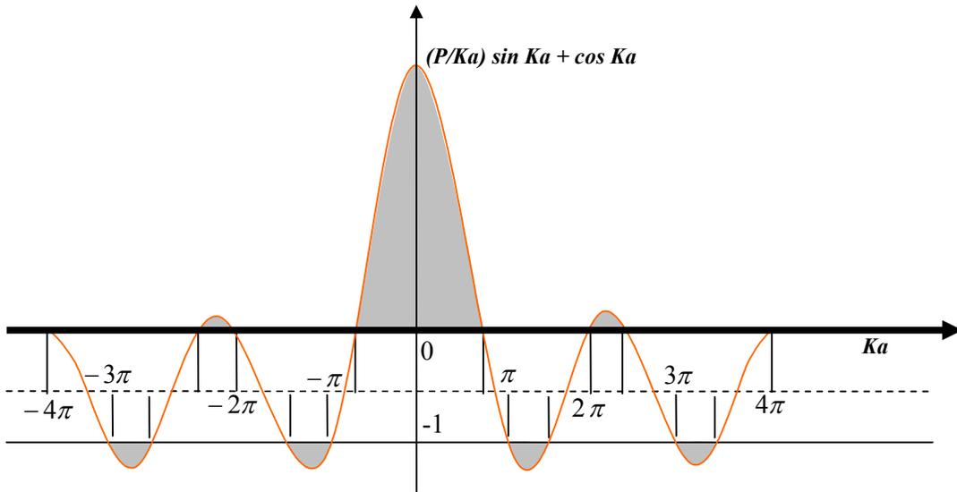
Gambar 5. Daerah dari fungsi  $(P/Ka)\sin Ka + \cos Ka$ , untuk  $P = 3\pi/2$ . Nilai energi  $E$  yang diperbolehkan pada daerah  $Ka = (2mE/\hbar^2)^{1/2}$  yang fungsinya anantara  $\pm 1$ . Nilai lain dari energi bukan gelombang yang berpindah-pindah atau seperti solusi Bloch dalam persamaan gelombang, jadi celah yang dilarang adalah bentuk spektrum energi.
