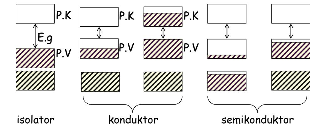
Gambar 1. Skema pita energi untuk isolator, logam, dan semikonduktor. Pita yang diarsir berarti terisi elektron.
