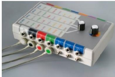
Untuk simulasi jantung buatan. Alat ini digunakan untuk kalibrasi ECG, karena dengan phantom ECG, kita dapat mengatur pola waveform ECG yang kita inginkan.
