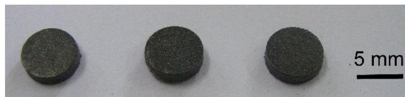
Gambar 3. Penampilan visual pelet keramik CuFe<sub>2</sub>O<sub>4</sub> ditambah campuran SiO<sub>2</sub>-TiO<sub>2</sub>-Al<sub>2</sub>O<sub>3</sub>.
