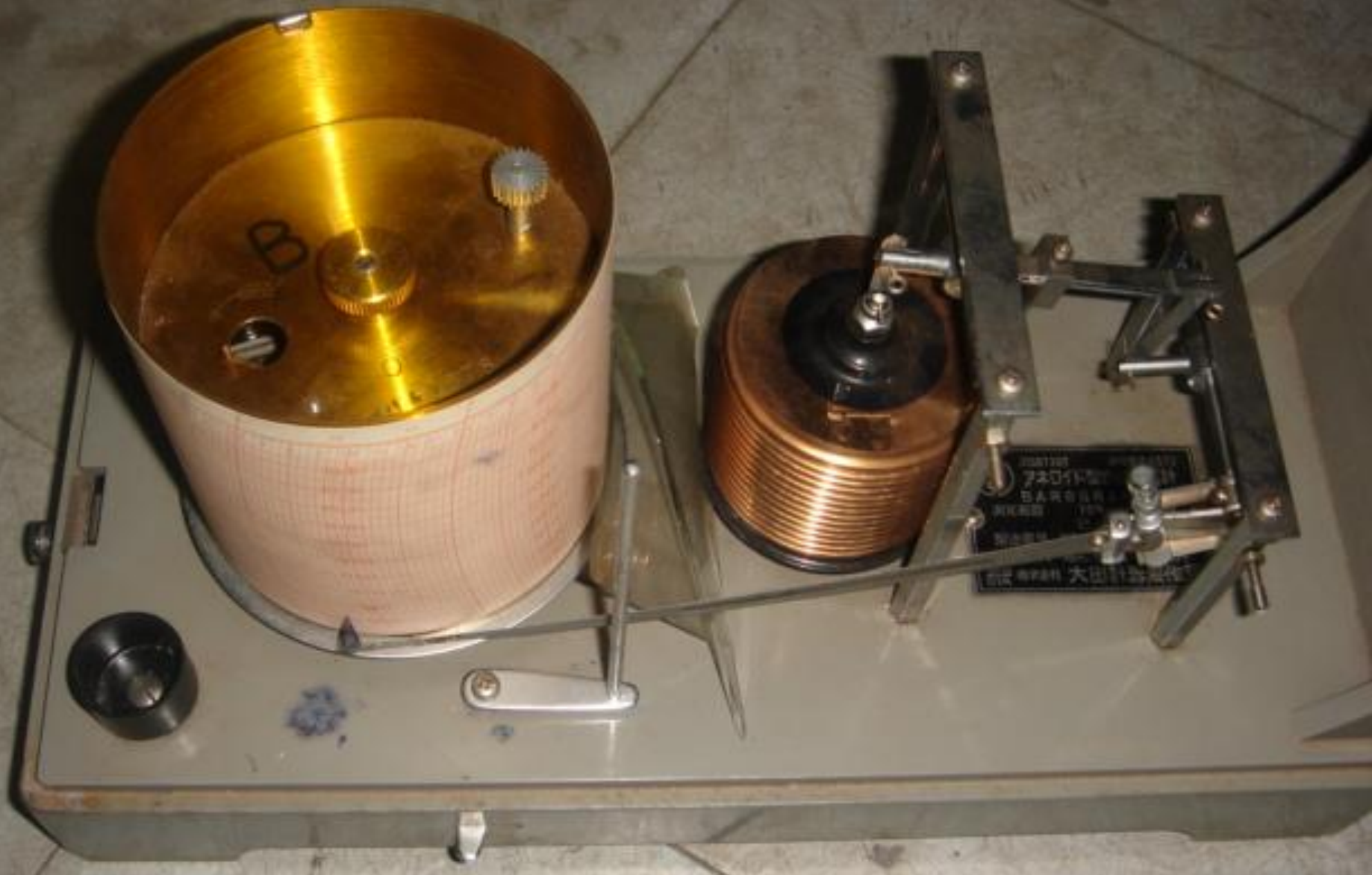
SISTEM PENCATAT BAROGRAF AUTOMATIC
