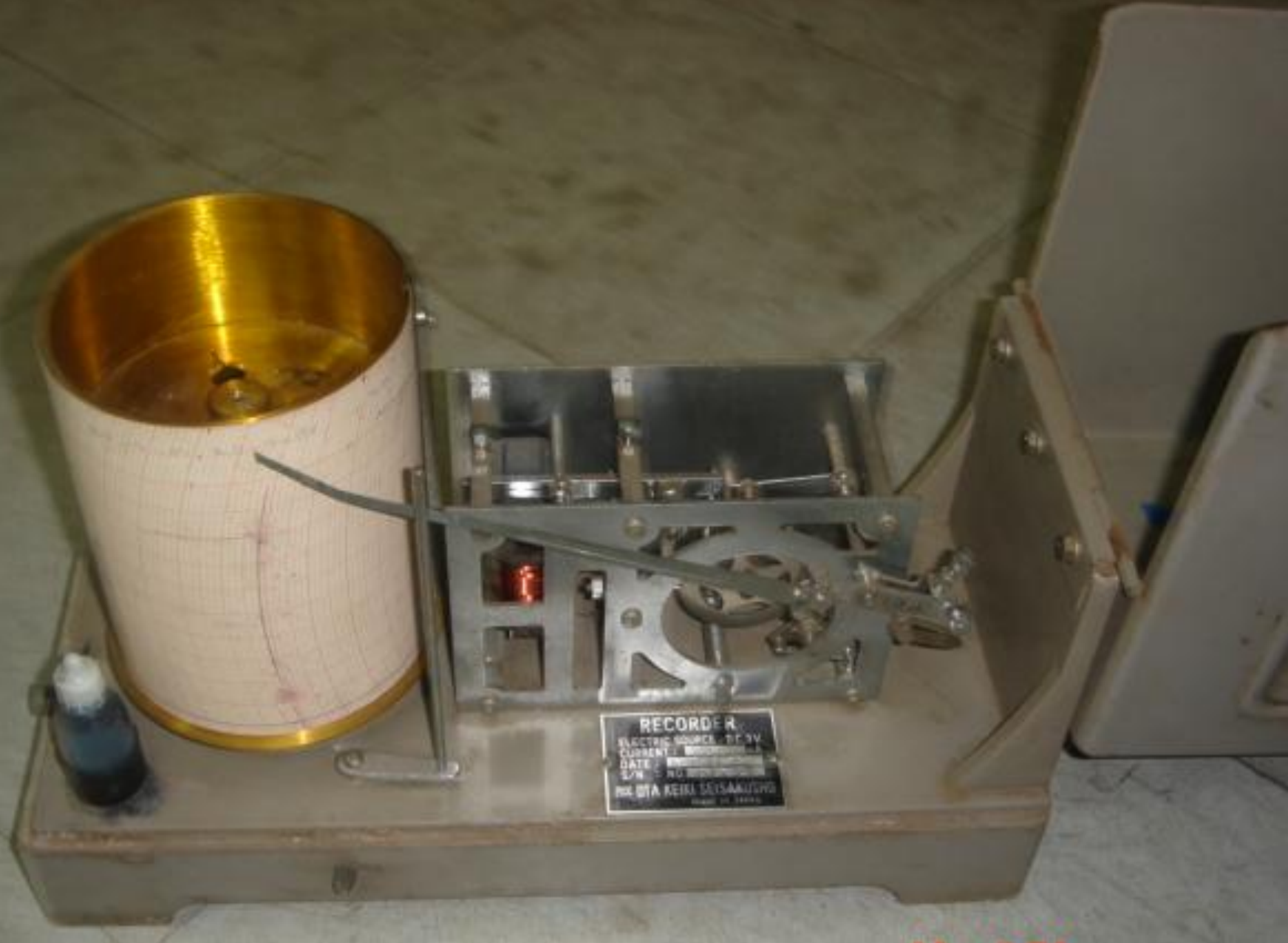
SISTEM PENCATAT DI BAGIAN DALAM ALAT PENGUKUR CURAH HUJAN AUTOMATIC
