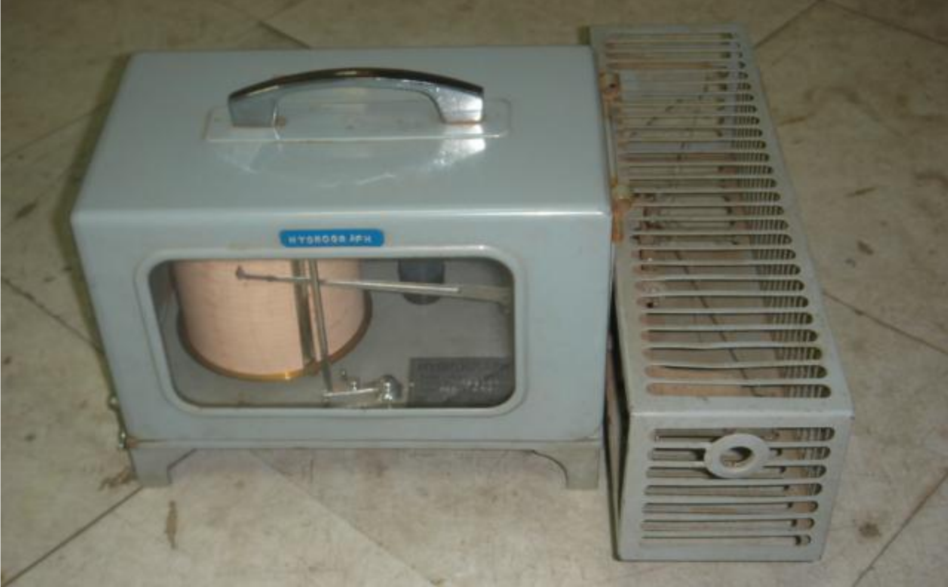
HYGROGRAPH ALAT PENCATAT KELEMBABAN UDARA AUTOMATIC SISTEM RAMBUT KUDA
