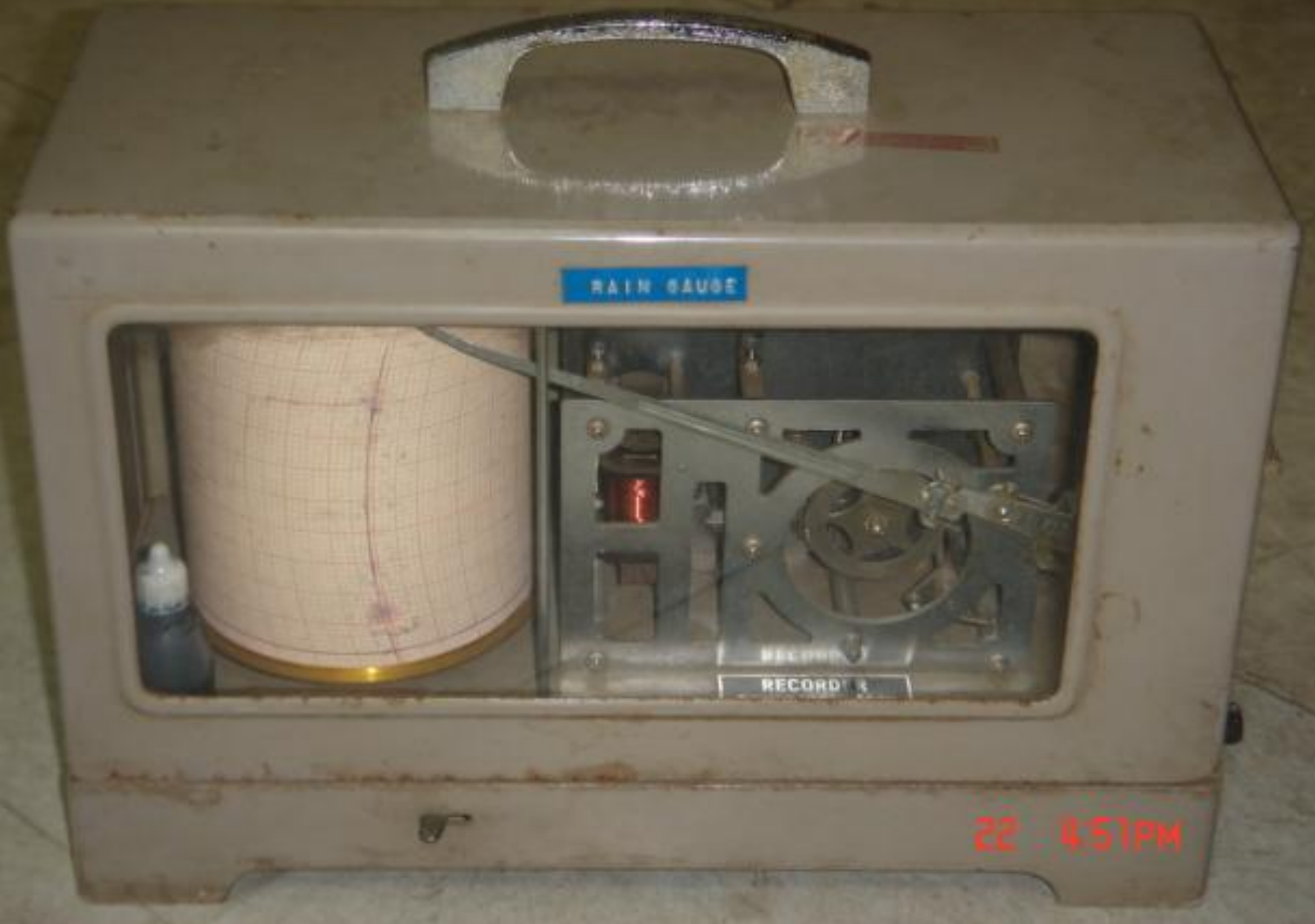
ALAT PENGUKUR CURAH HUJAN AUTOMATIC
